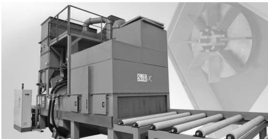
Fot. 1. Oczyszczarka wirnikowa z typoszeregu RATIOJET SciTeeX przeznaczona do mechanicznego przygotowania powierzchni za pomocą obróbki strumieniowo-ściernej
