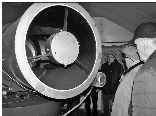
Teleskop ze zwierciadłem 60 cm odbierającym promienie lasera odbite od satelity
