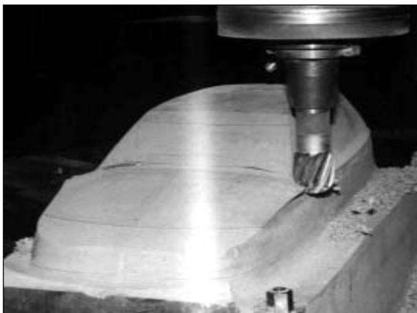
Model samochodu WARS podczas obróbki na OSN.
