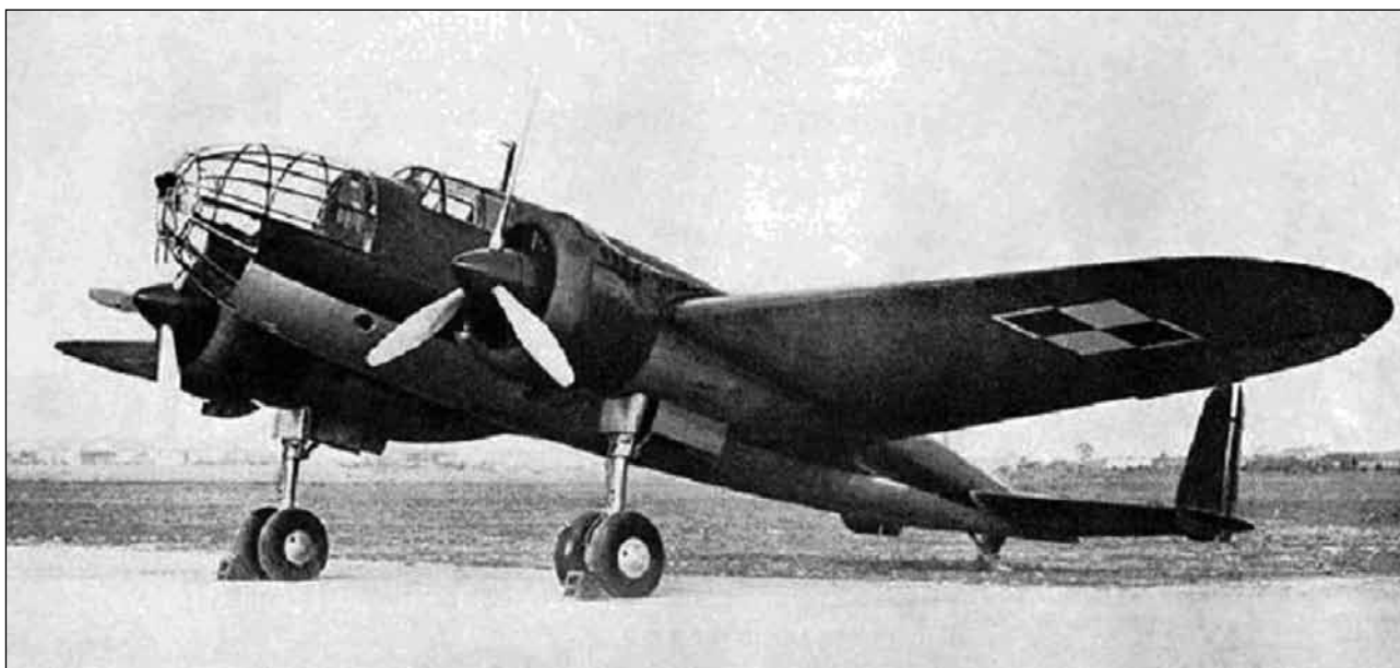
PZL P-37 Łoś z podwoziem Kubickiego i podwójnym usterzeniem pionowym 1938
