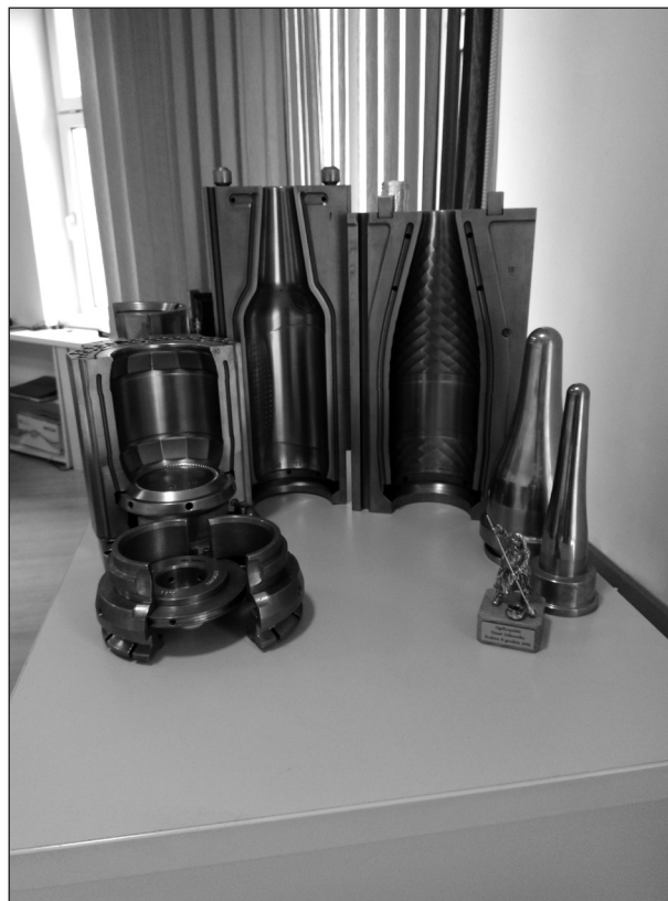
Wzory wykonanych odlewów po obróbce wiórowej
