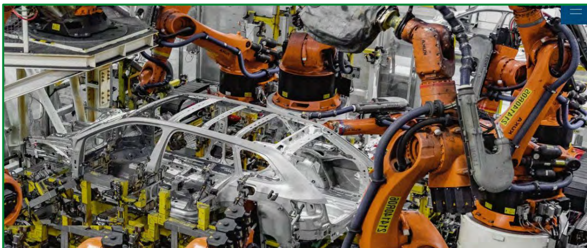
Testowanie linii automatycznej wykonania nadwozia samochodu
