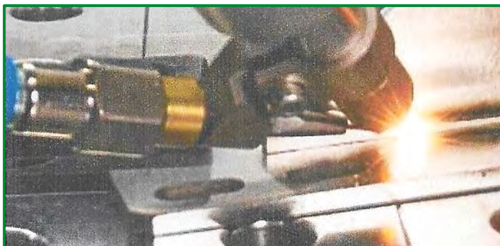
Sposób podawania drutu przy spawaniu laserowym
