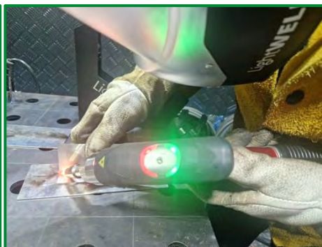
Pan Bartosz Trzeciak podczas spawania w mobilnej celi do spawania i czyszczenia laserowego
